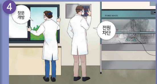
4 연구실 출입에 대한 안전 확보한 후 사고 확대방지 조치 Take safety measures after securing safety regarding entry to the lab
