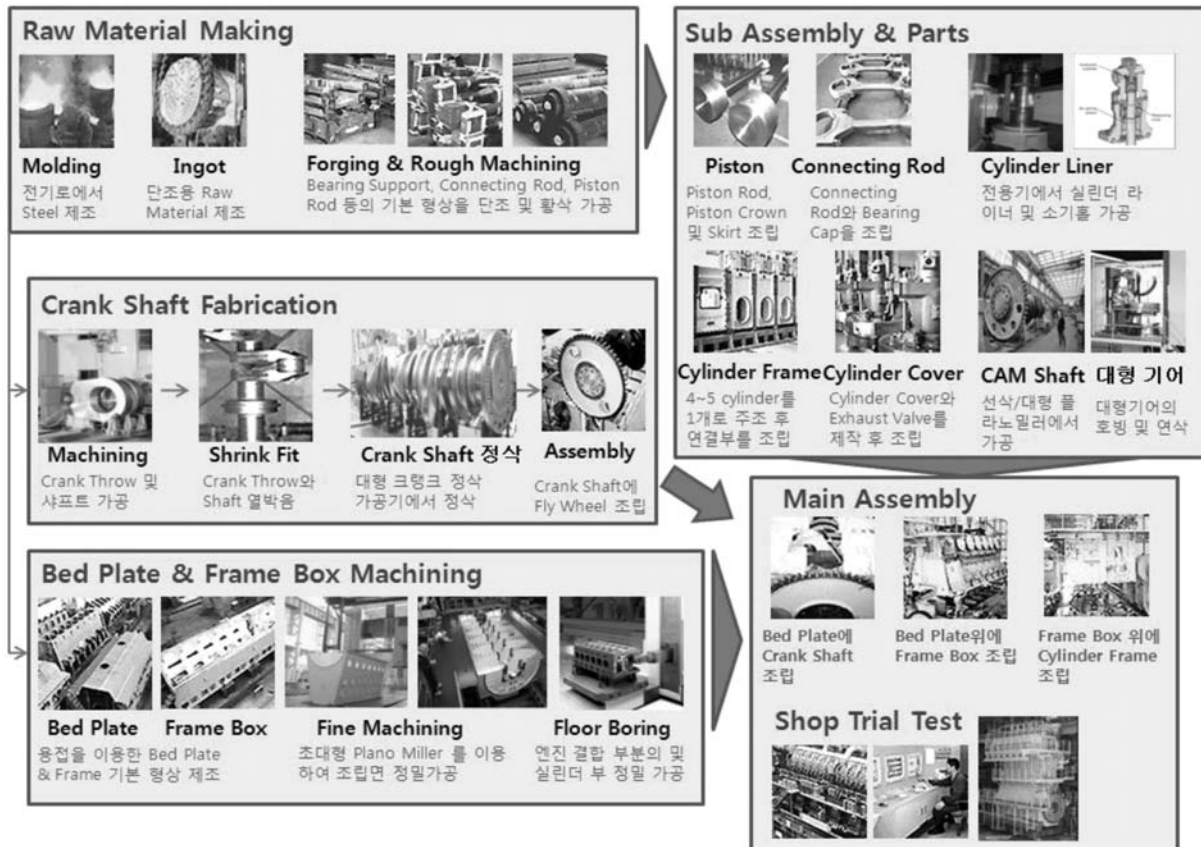
〈그림 4-5〉 첨단선박용 대형엔진 제조 공정
